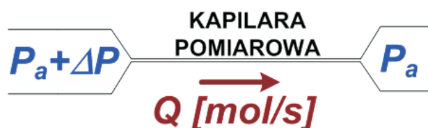
Rys. 1. Ideowy schemat działania przepływomierza
