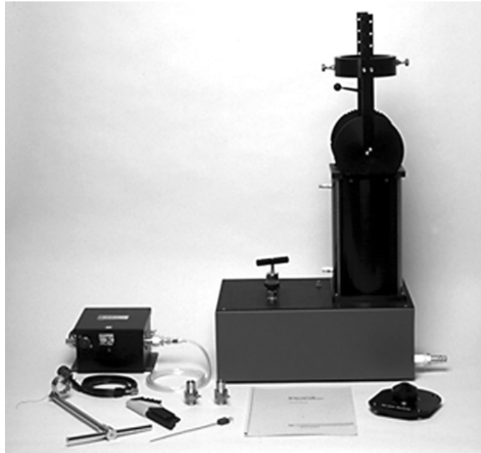
Rys. 1. Stanowisko wzorujące firmy TSI model 1129 [5]
