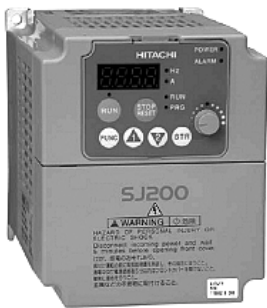
Rys. 2. Falownik Hitachi SJ200: Klasa zasilania 200 V Znamionowe napięcie zasilania: 200 do 240 V \pm 10\% , 50/60 Hz \pm 5\% , Wektorowe sterowanie z wykorzystaniem interfejsu RS485 obsługującego komunikację sieciową wg protokołu Modbus RTU
