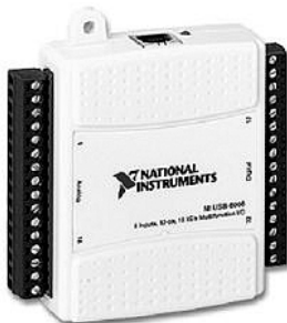
Rys. 4. Wielofunkcyjny moduł pomiarowy NI USB-6009 8 wejść analogowych w konfiguracji SE lub 4 wejścia w konfiguracji DI, 14/13 bitowy przetwornik A/D SE/DI, zakres wejściowy \pm 20 V, próbkowanie z częstotliwością 48/42 kHz, dwa 12 bitowe wyjścia analogowe pracujące z częstotliwością do 150 S/s
