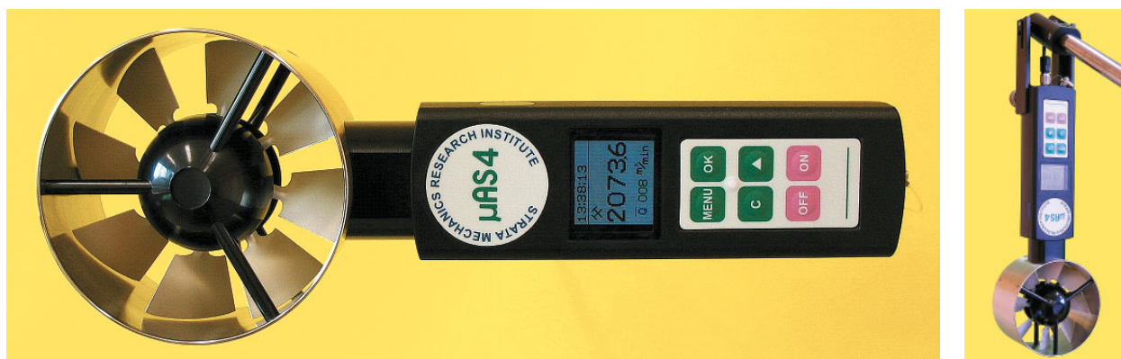
Fot. 1. Anemometr skrzydełkowy \mu AS4. Głowica przegubowa wysięgnika
