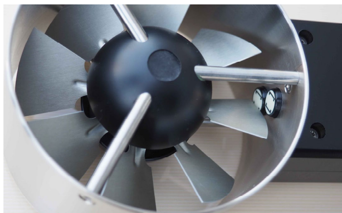
Fot. 6. Czujnik prędkości i kierunku obrotów
