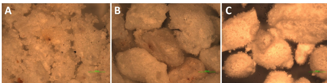
Rys. 4. Struktura zeolitu SN a) uziarnienie 100-160, b) uziarnienie 200-250, c) MOF MIL-140
