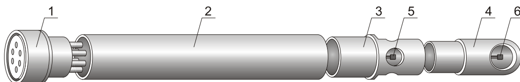
Rys. 1. Rysunek złożeniowy zintegrowanej sondy termoanemometrycznej w obudowie
