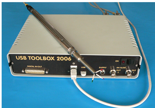
Fot. 1. Termooanemometryczny system wyznaczania składowych wektora prędkości przepływu
