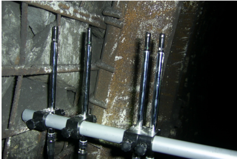
Fot. 3. Matryca głowic termooanemometrycznych w warstwie przyściennej na zbliżeniu
