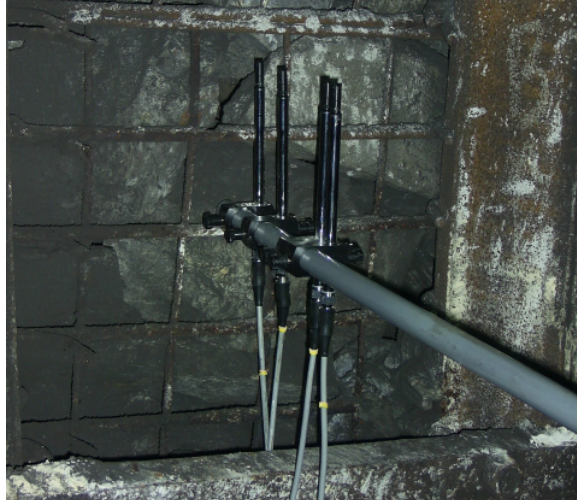
Fot. 2. Matryca głowic termooanemometrycznych w warstwie przyściennej
